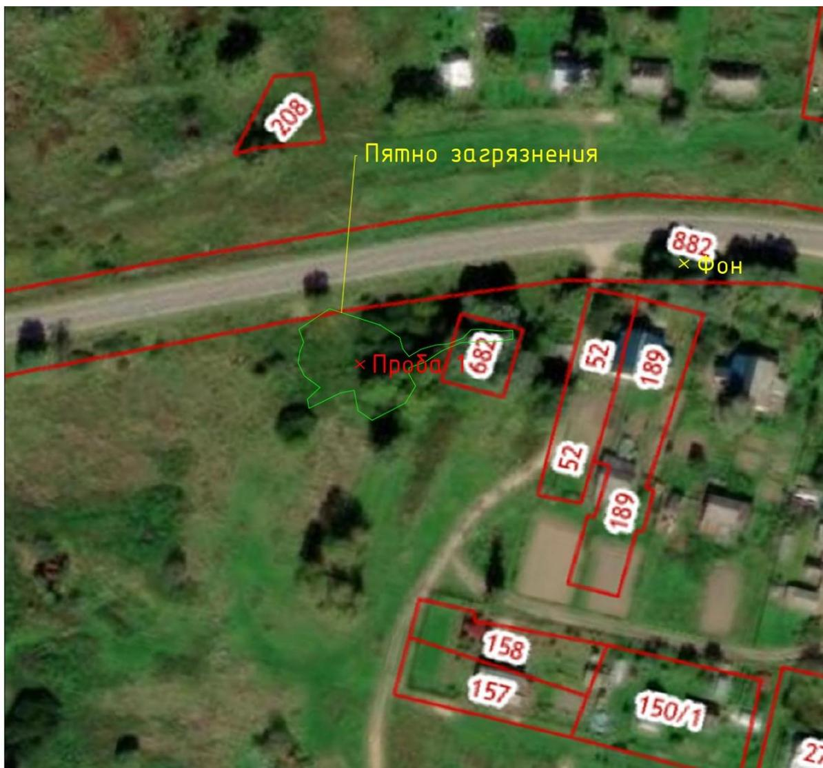
Фактическая площадь участков с почвенным покровом, загрязнённых сточными водами, определялась визуально и уточнялась с помощью ГНСС-приемником модели «S-MaxGEO» (свидетельство о поверке № С-ГСХ/21-06-2022/165100970 ООО «ЦИПСИ НАВГЕОТЕХ-ДИАГНОСТИКА», действительно до 20 июня 2023 г.).
